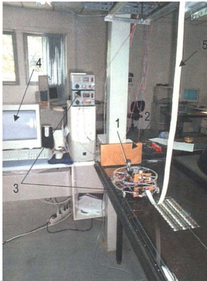
Fot. II. Doświadczalny postument do badań absolutnie sprężystego uderzenia korpusu czterowymiarowego żyroskopu o ściankę: 1) czterowymiarowy żyroskop; 2) płyta udarowa; 3) aparatura pomiarowa; 4) komputer do opracowania wyników; 5) łączący tren.
